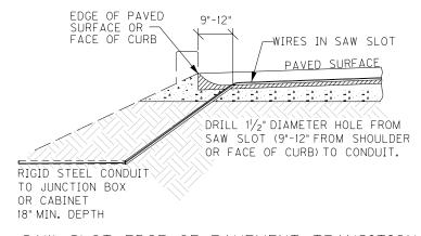
SAW SLOT EDGE OF PAVEMENT TRANSITION
